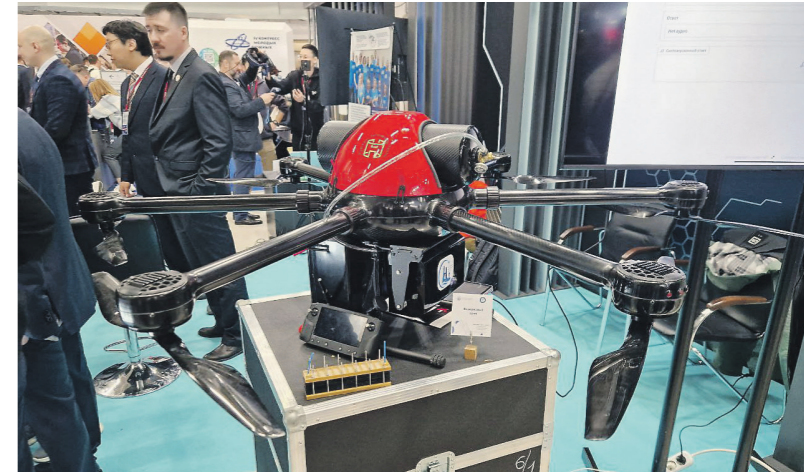
Этот беспилотник, работающий на водородном топливе, способен непрерывно летать до четырёх часов
